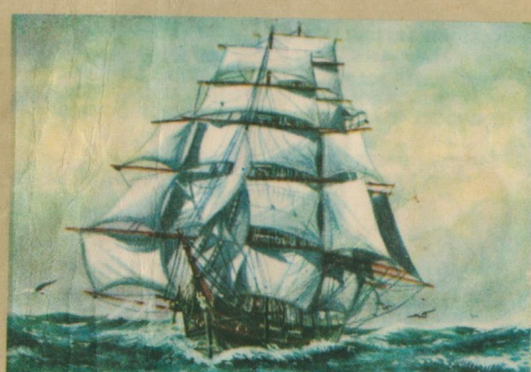
Clipper, 19e siècle. - Perfection du voilier. Effectuait des traversées plus rapides que les vapeurs, grâce à une coque aquadynamique et une voilure énorme. Transport de marchandises légères: thé, laine, coton.
